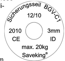
Ein Saveking® Sicherungsseil kann einsträngig oder zweisträngig (eingeschlagen) zur Sicherung von Geräten eingesetzt werden. Die Angaben auf der Plakette beziehen sich auf die einsträngige Sicherungsmethode. Saveking® Sicherungsseile sind nach BG-Prüfbescheinigung MO 105107 für folgende maximale Gerätegewichte zugelassen:
